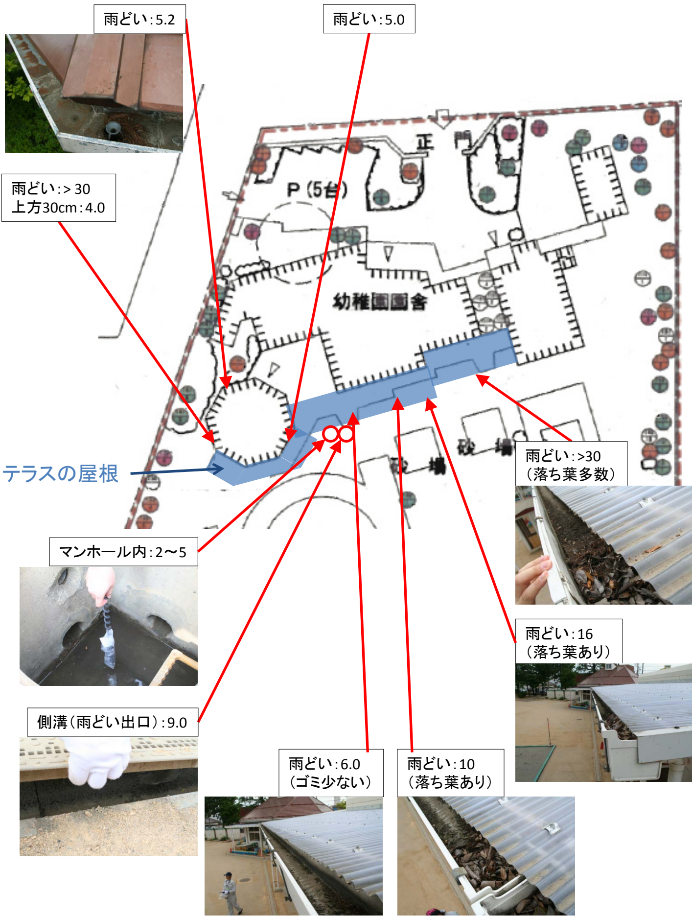
図4-10 幼稚園園舎雨樋等測定記録
